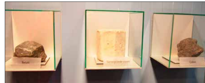
De basis van steenwol: basalt, gerecyclede steen en cokes
