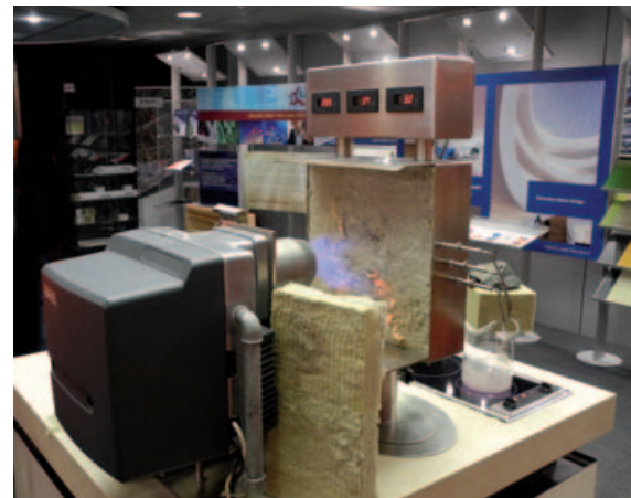
Afb. 3 Een testopstelling waarmee de hittebestendigheid en warmte-isolerende kwaliteit van steenwol wordt gedemonstreerd
